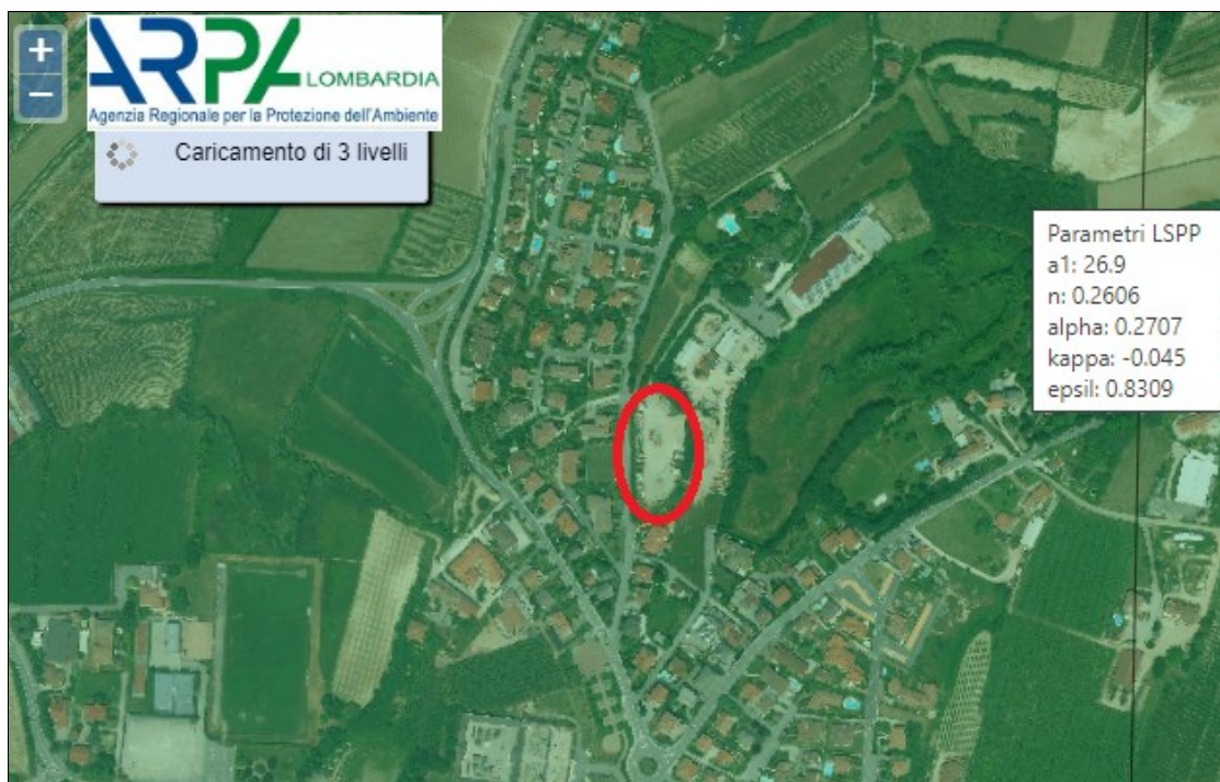
Fig. 9 - Individuazione dell’area pluviometrica omogenea e dei parametri pluviometrici utili forniti dal sito Web ARPA Lombardia.
