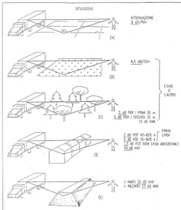
**Figura 3.2.1: schematizzazione dei principali fattori di attenuazione**
