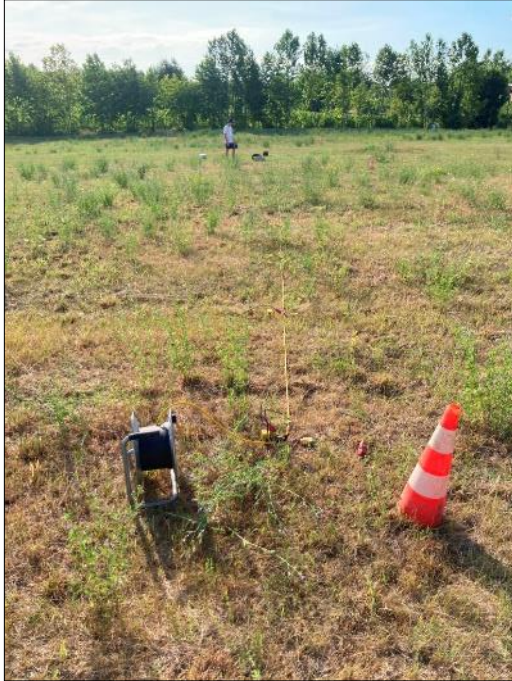
Stendimento sismico M.A.S.W.
