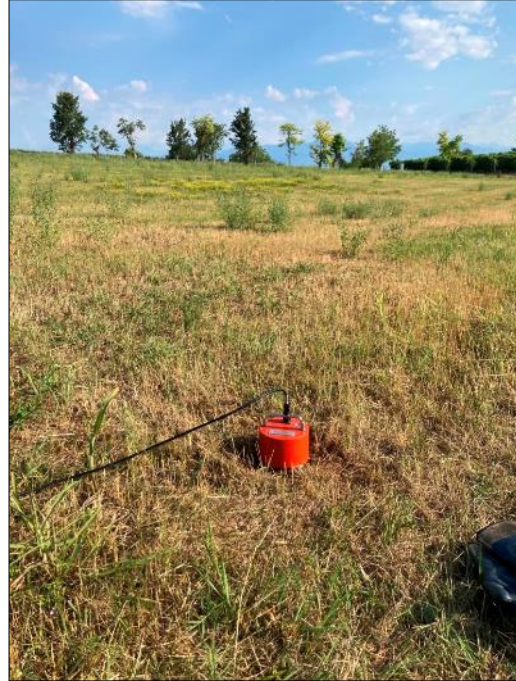
Misura del microtremore sismico mediante tecnica H.V.S.R.
