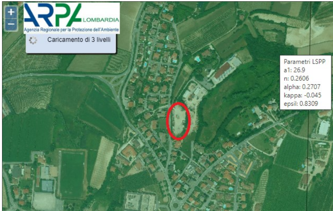
Fig. 8 - Individuazione dell'area pluviometrica omogenea e dei parametri pluviometrici utili forniti dal sito Web ARPA Lombardia.
